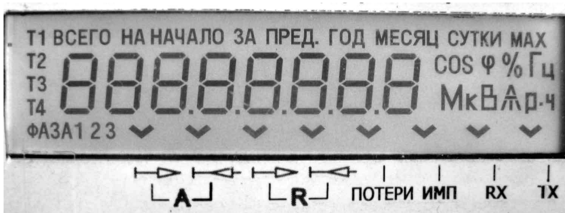
Рисунок 5 – Внешний вид ЖКИ с включенными элементами индикации
