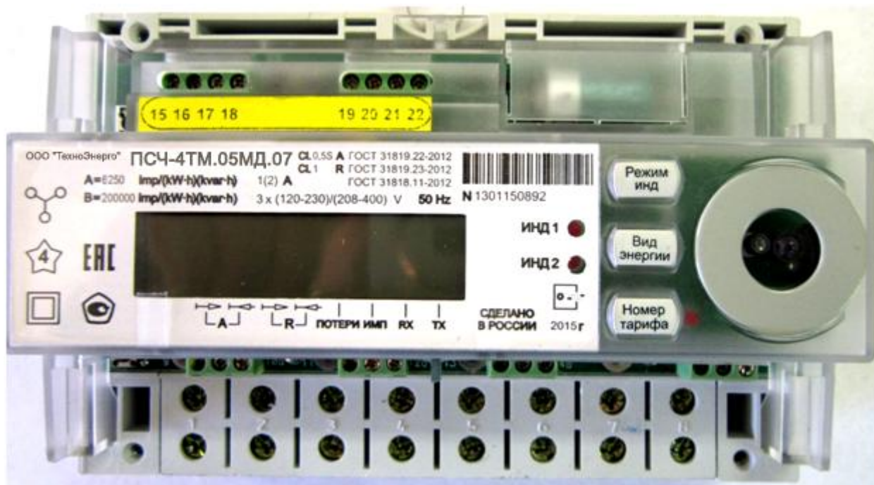
Рисунок 2 - Внешний вид счетчика ПСЧ-4ТМ.05МД со снятыми крышками
