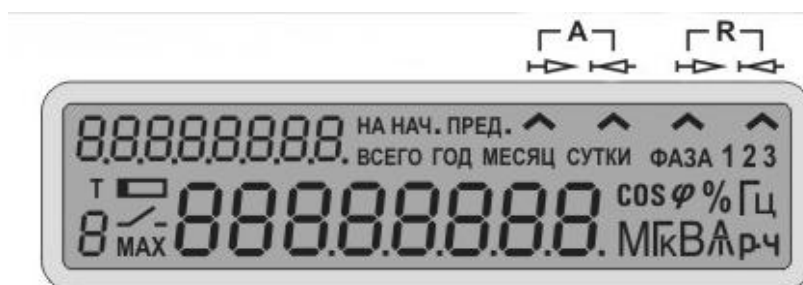
Рисунок 8 - Внешний вид ЖКИ счетчиков для установки на DIN-рейку с включенными элементами индикации
