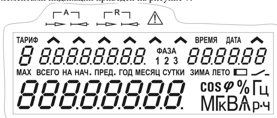
Рисунок 7 – Внешний вид ЖКИ счетчиков внутренней установки с включенными элементами индикации
