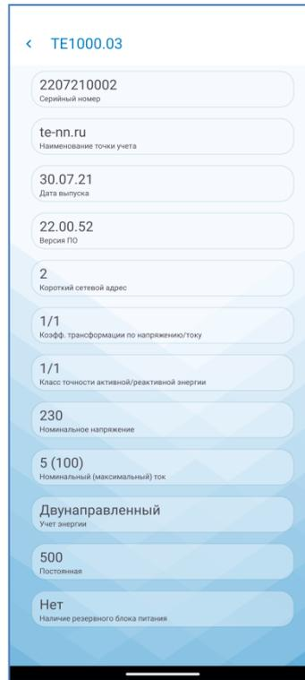
Рисунок 4 – Раздел «Об устройстве» мобильного приложения «Конфигуратор ТЭ»
