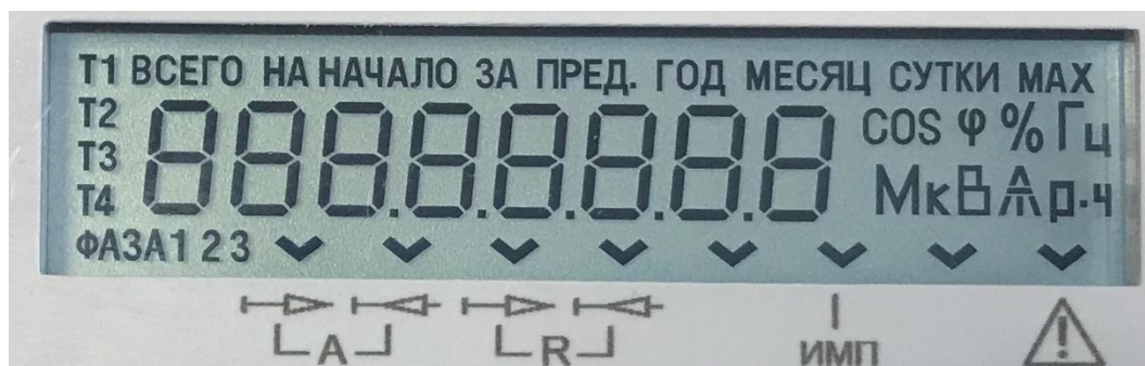
Рисунок 4 - Внешний вид ЖКИ с включенными элементами индикации
