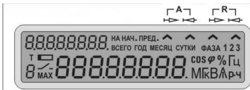
Рисунок 6 - Внешний вид ЖКИ счетчиков для установки на DIN-рейку с включенными элементами индикации
