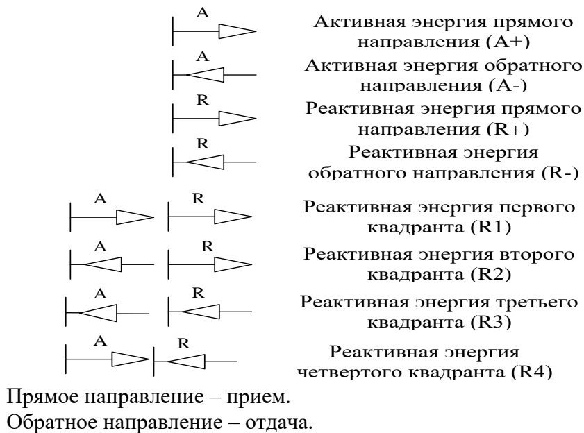
Рисунок 4 – Условные обозначения направления энергии, нанесенные на шкалу счетчика
